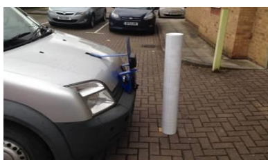
Изображение столба высотой 1 м перед камерой на высоте 0,6 м
